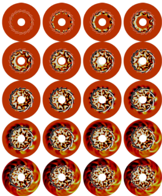
Pression acoustique dans le ventilateur AMS - CFD-Kit-EEL
